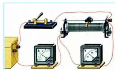
При движении ползунка реостата влево или вправо показания амперметра изменяются. График зависимости силы тока в цепи представлен на рисунке.
